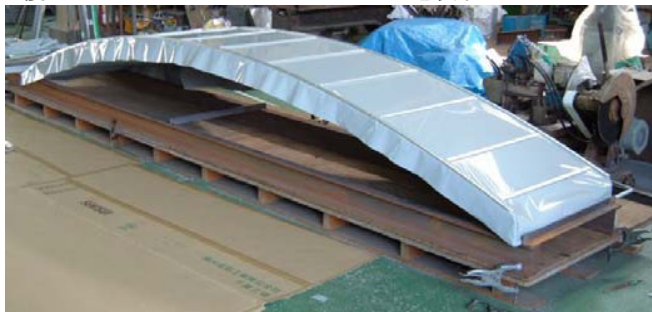
・覆蓋ユニット(フレームにETFEフィルムを装着)
