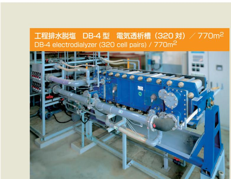
工程排水脱塩 DB-4 型 電気透析槽 (320 対) / 770m<sup>2</sup>
