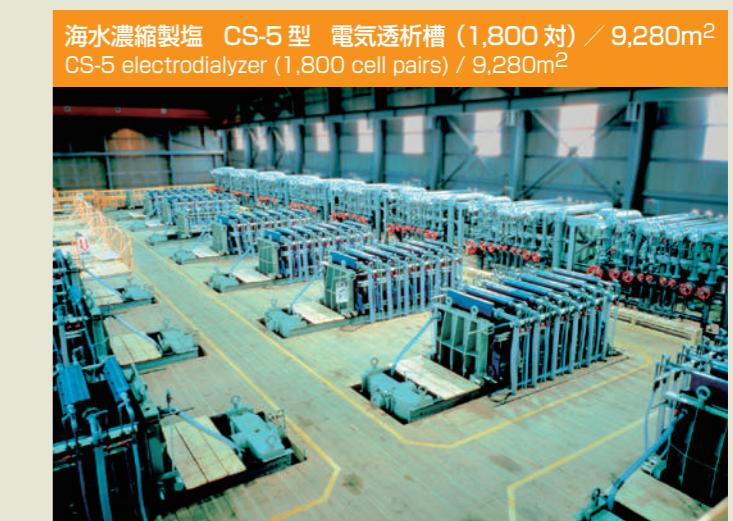
海水濃縮製塩 CS-5 型 電気透析槽 (1,800 対) / 9,280m<sup>2</sup>
